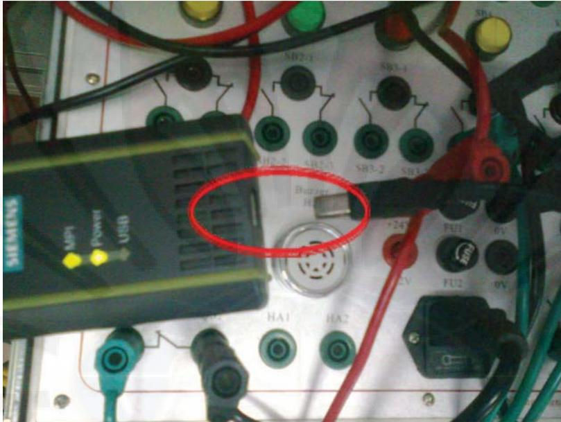
Gambar L-9 Melepas Jalur USB-Hub Secara Manual
