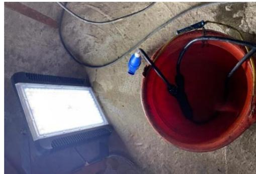
**Gambar 7** Percobaan Perendaman Sambungan *Waterproof Connector* Dalam Air. (Sumber: Putra Sinaga, Proyek JPAL 1 dan 3 KIPP IKN, 2024)
