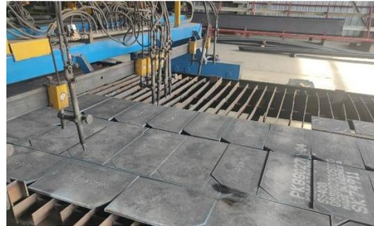
**Gambar 3** Pemotongan *Plate* Baja Menggunakan CNC pada Tanggal 25 Januari 2022
