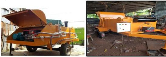
**Gambar 2** Mesin Penyemprot Aspal Jalan *Portable*
