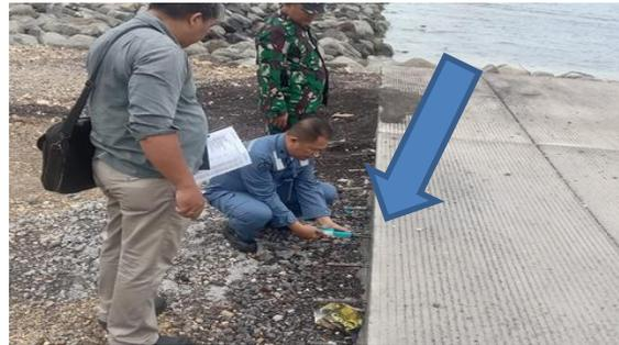
**Gambar 3** Pengujian Kekuatan Mutu Beton
