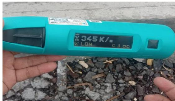
**Gambar 4** Hasil Uji Kuat Tekan Beton Pelat Lantai
