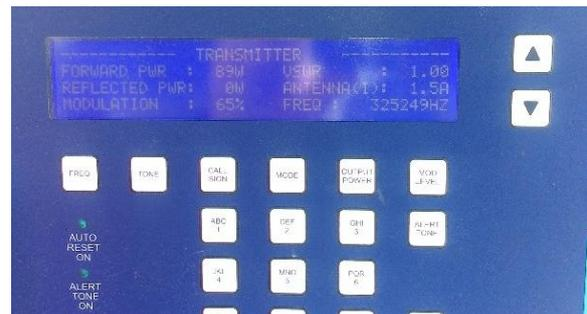
**Gambar 8** Parameter NDB Portable pada LCD Display
