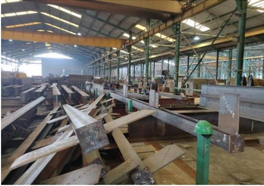
**Gambar 5** Penumpukan *Column* di Lini Produksi
