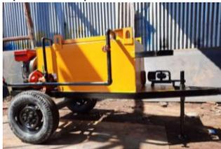
**Gambar 3** Mesin Penyemprot Aspal *Mini Portable*
