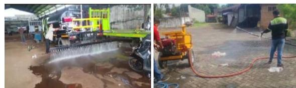
**Gambar 5** Uji Coba Penyemprotan Mesin Penyemprot Aspal Distributor dan Mesin Penyemprot *Mini*
