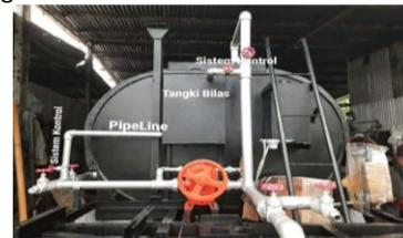
**Gambar 4** Penambahan Komponen Mesin Penyemprot Aspal (Tangki Bilas, Sistem Kontrol, Pipa Saluran Bilas)
