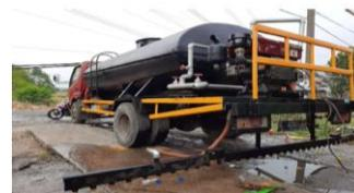
Gambar 1 Mesin Penyemprot Aspal Jalan Distributor
