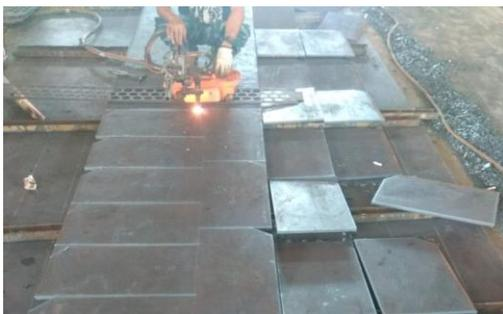
**Gambar 2** Pemotongan *Plate* Baja Secara Manual pada Tanggal 20 Januari 2022
