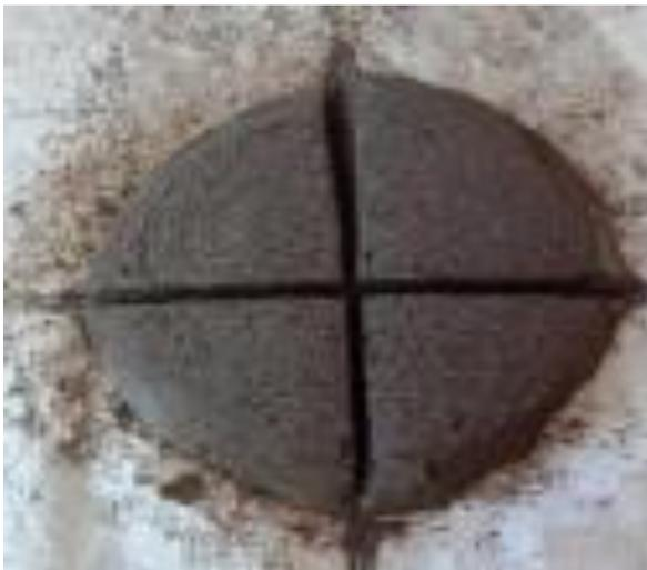
**Gambar 5** Konsentrat Hasil Konsentrasi Menggunakan *Shaking Table*
