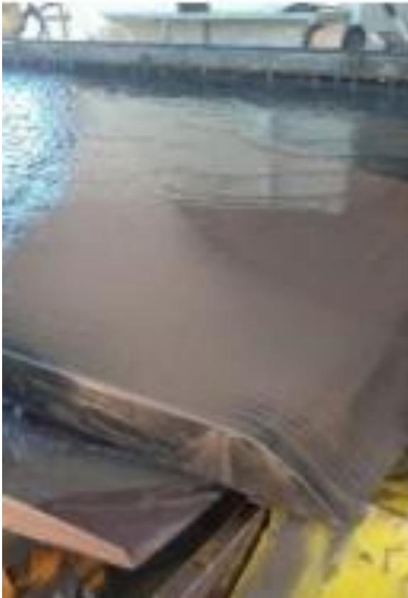
**Gambar 4** Proses Konsentrasi Menggunakan *Shaking Table*
