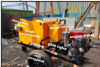
Gambar 8 Komponen Mesin Penyemprot Aspal
