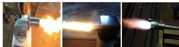
Gambar 7 Burner ( Elektrik, Kompresor, Blower LPG )
