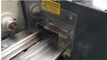
**Gambar 4** Contoh Modifikasi Mesin dengan Penambahan Cover Mesin
