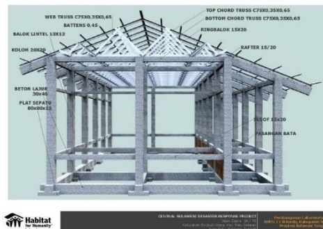
Gambar 13 Struktur Bangunan dari Bangunan Bawah hingga Atas
