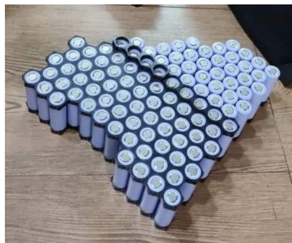
Gambar 4 Penyusunan Cell Battery
