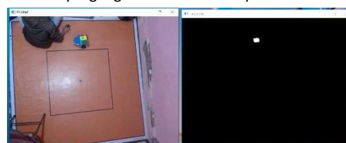
Gambar 10 (a) Original Kamera dan (b) Threshold Warna Kuning Kamera
