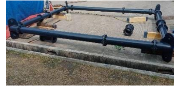
Gambar 6 Fabrikasi Square Spreader bar
