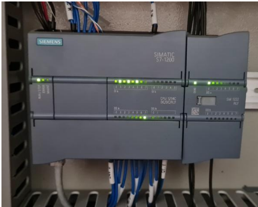
Gambar 4 PLC yang digunakan pada proses regenerasi
