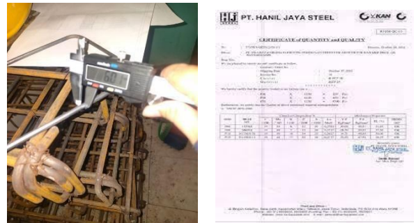
Gambar 6 Cek Ukuran actual diameter besi dan sertifikasi besi
