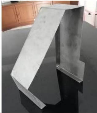
Gambar 5 Pembentukan Wadah Battery dengan Sheet Metal
