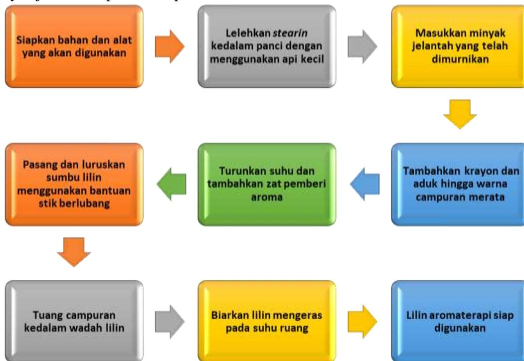
Gambar 2. Diagram Alir Pembuatan Lilin Aromaterapi Berbahan Dasar Minyak Jelantah.
