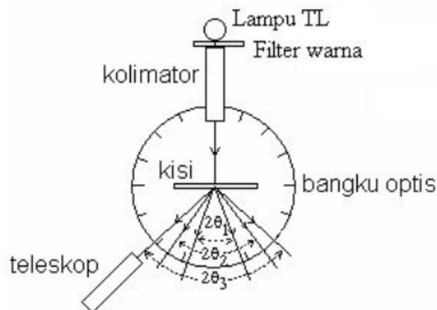
Gambar 4 sketsa eksperimen spektrometer kisi difraksi
