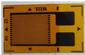
Gambar 2a. Foto sebuah *strain gauge*
