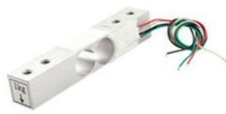
Gambar 2b. Bentuk objek dimana *strain gauge* ditempelkan
