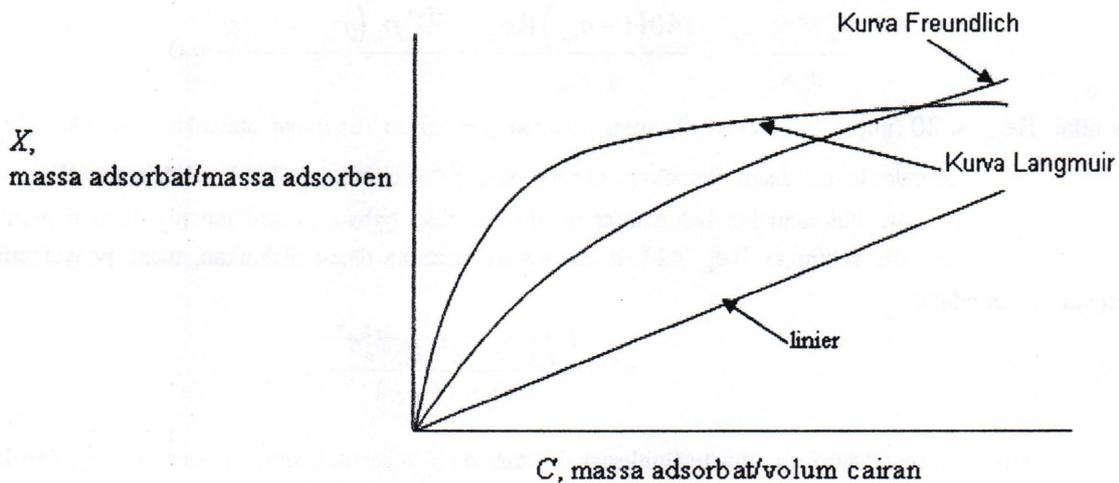
Gambar 1. Beberapa tipe kurva ketimbangan (isoterm) adsorpsi
