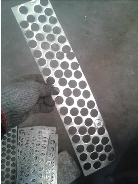
Gambar 4.4.2. Plat baja setelah di plong
