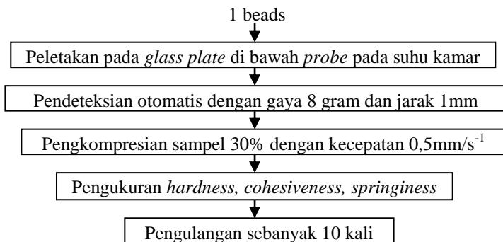
Gambar 4.4. Diagram Alir Pengujian Tekstur Beads
