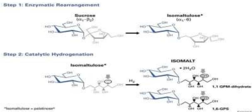
Gambar 2.3. Tahapan Proses Pembuatan Isomalt
