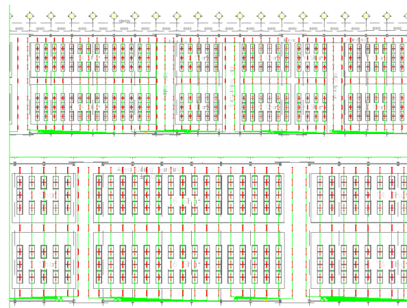
Gambar 4. Instalasi Lampu Penerangan Gedung Produksi
