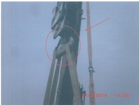
Gambar 7. Arrangement Webbing Sling dari Main Hook Crane 250T
