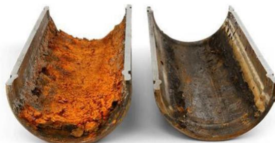
Gambar 1. Contoh Pipa yang Telah Korosi Akibat Pengendapan FeS
