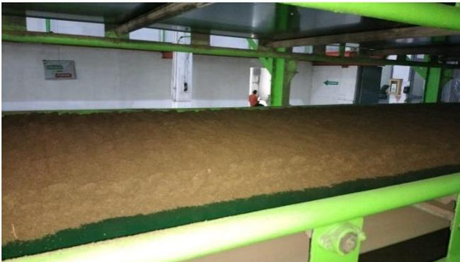
Gambar 5.6. Proses oksidasi enzimatis
