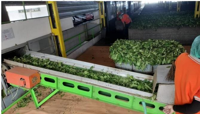
Gambar 5.5. Proses turun layu pada conveyor *Green Leaf Shifter*
