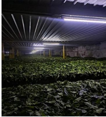
Gambar 5.4. Proses pelayuan pucuk daun teh pada *withering trough*
