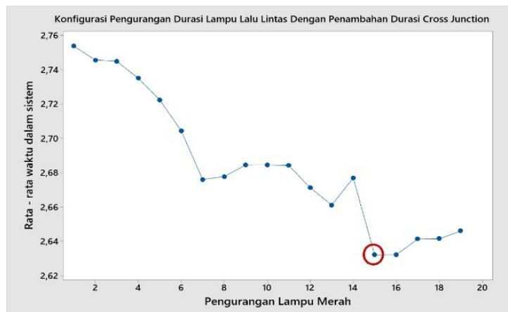
Gambar 7. Konfigurasi Waktu Lampu Lalu Lintas dan *Cross junction*
