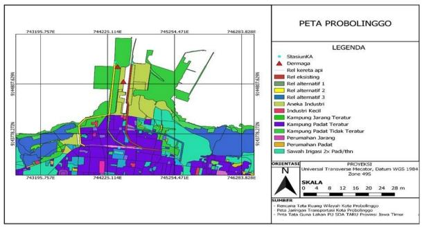
Gambar 1. Layout Peta Kota Probolinggo dan Trase Eksisting serta Trase Alternatif Sumber: Analisis QGis
