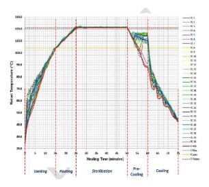
Gambar 2. Distribusi temperature pada trial 2
