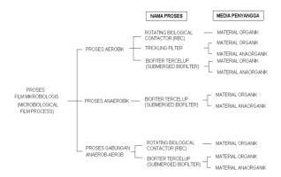
Gambar 2. Klasifikasi cara pengolahan air limbah dengan proses film mikro-biologis (proses biofilm).
