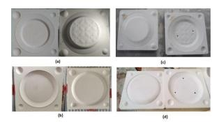
Gambar 8. Produk cetakan piring berbahan gypsum: (a) master cetakan dining plate dari CNC router; (b) master cetakan piring couple dari CNC router; (c) mold cetakan dining plate; (d) mold cetakan piring couple
