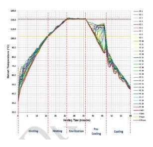
Gambar 1. Distribusi temperature pada trial 1
