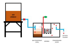
Gambar 4. Penampang Bioreaktor Unggun Tetap Aerobik untuk pengolahan air limbah yang digunakan untuk percobaan
