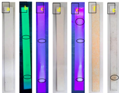
Gambar 1. Hasil uji KLT hasil fermentasi kulit buah naga yang telah diuapkan 8 \mu l dengan fase gerak n -butanol, asam asetat dan air (4 : 1 : 5)
