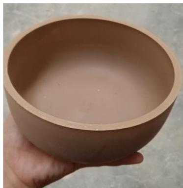
Gambar 1.5 Hasil Proses Cetak *Jigger*
