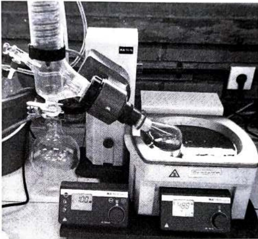
Gambar 4.5. Rotary evaporator untuk memperoleh campuran kurkumin-MSN.
