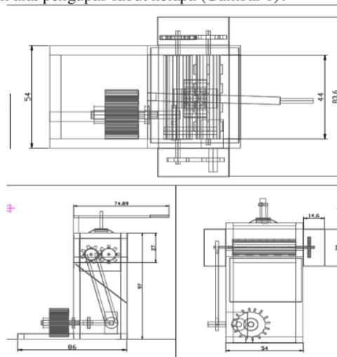
Gambar 1. Desain Alat Pengupas Sabut Kelapa
