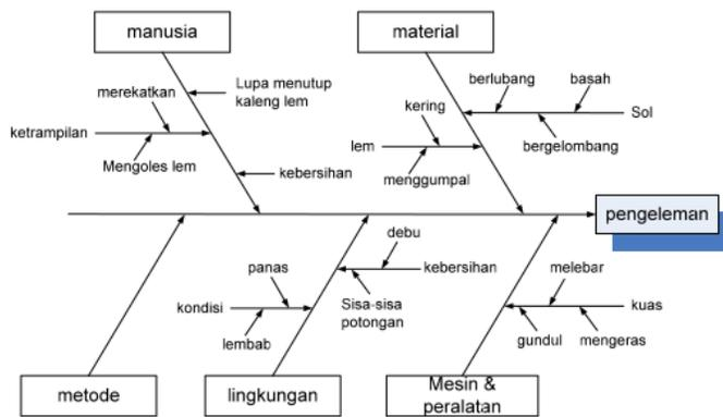
Gambar 4. Fishbone diagram kategori kecacatan bagian Pengeleman
