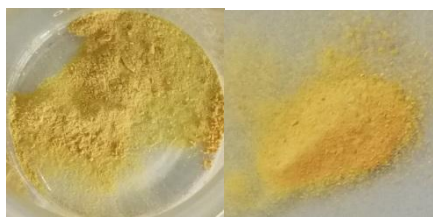
Gambar 7. Nanomaterial (kiri) MCM-41 dan (kanan) IBN yang sudah di-loading ekstrak kulit jeruk purut
