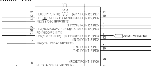
Gambar 16. Hubungan mikrokontroler dengan rangkaian penerima sinyal
