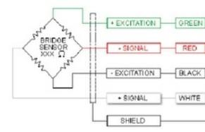
Gambar 2c. Konvensi warna kabel dan sinyal pada *loadcell*
