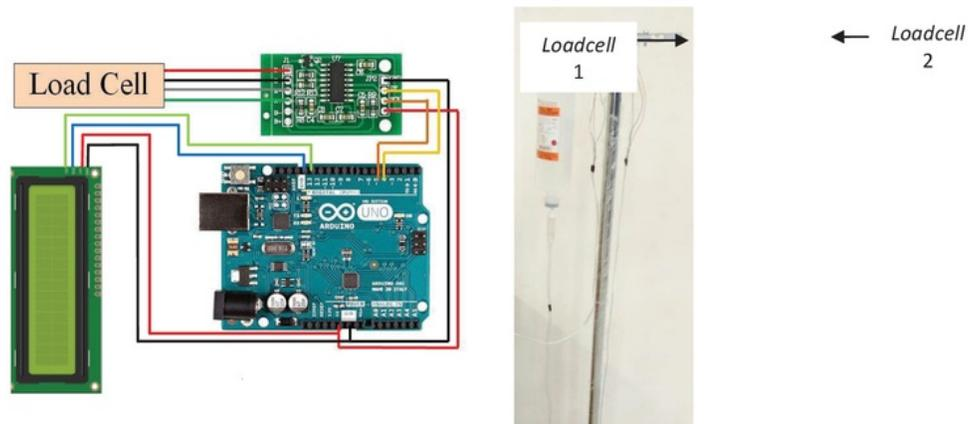
Gambar 6a. Sistem untuk monitor cairan infus dengan Arduino, modul HX11 dan tampilan LCD 2x16 karakter
