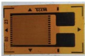
Gambar 2a. Foto sebuah *strain gauge*
