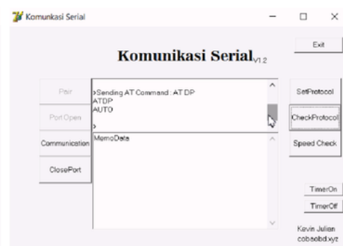
Gambar 3b. Konfirmasi model AUTO pada OBD-II dengan perintah AT DP
