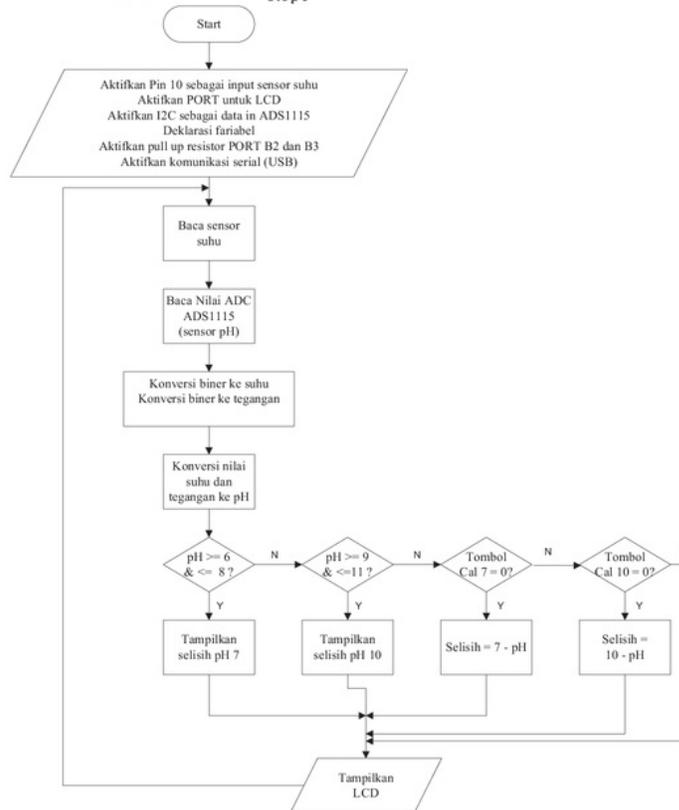
Gambar 8. Diagram alir perangkat lunak
