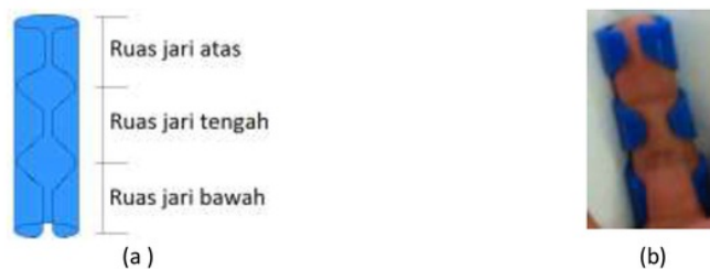
Gambar 7. Model pelindung jari, a. rancangan pelindung jari, b. contoh saat digunakan
