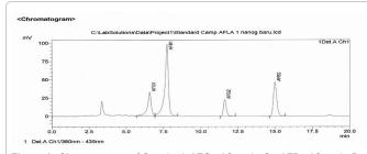
**Figure 3:** Chromatogram of Standard:  $AFG_1$ , Aflatoxin  $G_1$ ;  $AFB_1$ , Aflatoxin  $B_1$ ;  $AFG_2$ , Aflatoxin  $G_2$ ; and  $AFB_2$ : Aflatoxin  $B_2$ .
